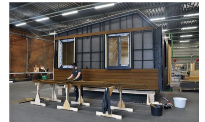
Als prefabbouwer kan Tala de woningmodules in de eigen fabriek ontwerpen, ontwikkelen en produceren, inclusief de plaatsing van ramen en deuren.
